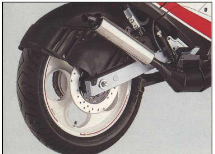
Foto; De expansie uitlaat voor straat gebruik iets te weinig gedempt
